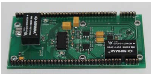
شکل ۵- بخش آنالوگ زیرمجموعه ثبت داده‌های آکوستیک
