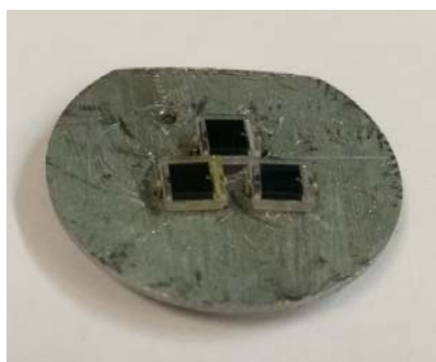
شکل ۵- فوتودیوهای BPW34 سوار شده بر پولک آهنی برای پرتودهی با پروتون‌های ۳۰ MeV توسط سیکلوترون کرج
