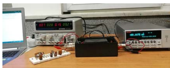
شکل ۶- چیدمان آزمایش جهت اندازه‌گیری پارامترهای الکتریکی فوتودیودها
