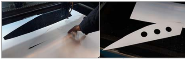
شکل ۱۲- برش لیزر شابلون ایرفویل دارای Cross point
