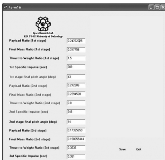
شکل ۳- منوی ورودی محاسبه توزیع جرم مراحل به روش آماری
