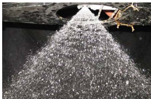
شکل ۱۲- نمایش حات کاملاً توسعه یافته Fully developed چتر پاشش انژکتور در فشار نامی
