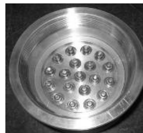
شکل ۶- نمای قرارگیری انژکتورها دایروی درون پولک جداکننده
