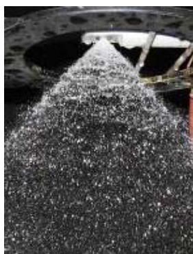
شکل ۱۰- نمایش زاویه چتر پاشش تشکیل شده از نازل داخلی
