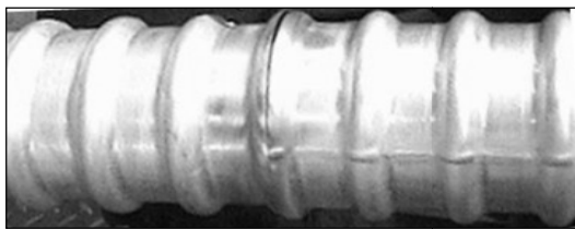
شکل ۵- جوشکاری قسمت‌های مختلف لوله موج‌دار
