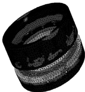
شکل ۴- توزیع تنش در مجموعه جدایش
