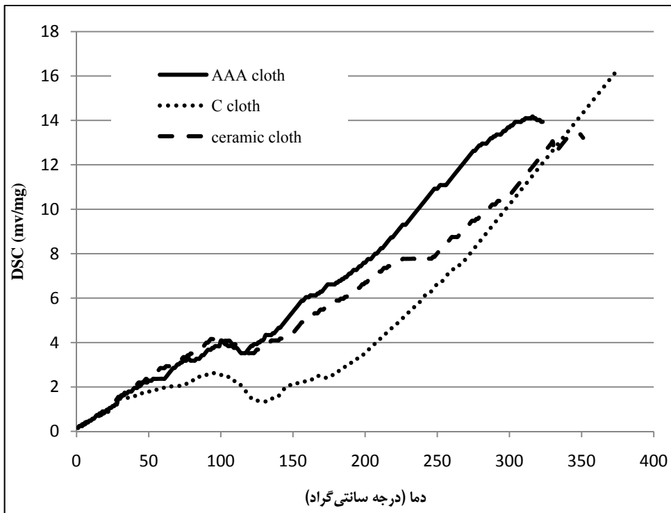
شکل ۸- منحنی‌های ظرفیت حرارتی ویژه قطعات کامپوزیتی
