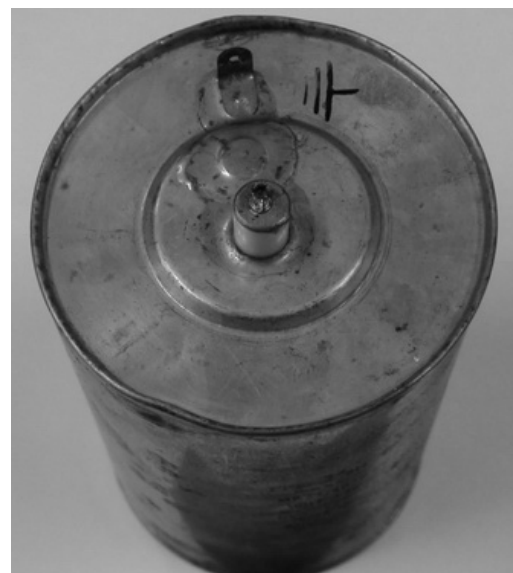
شکل ۵- تصویر خازن اصلی مورد استفاده در رانشگر
