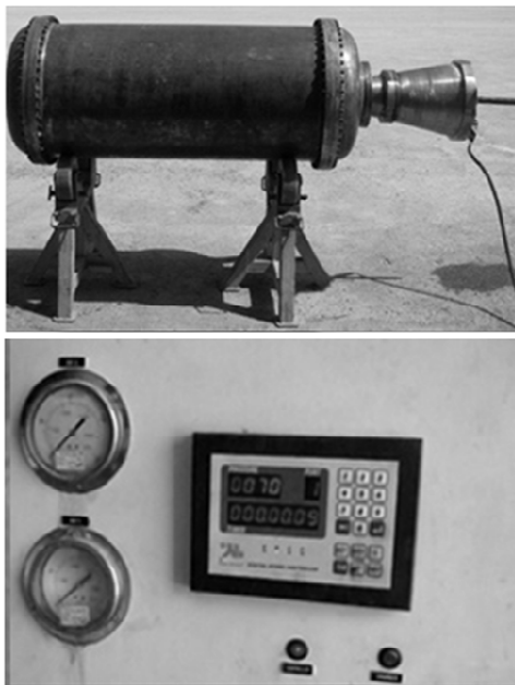
شکل ۸- موتور با اتصال انعطاف‌پذیر در آزمایش هیدرواستاتیک ۷۰ بار
