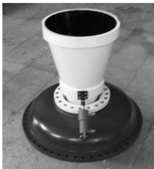
شکل ۱۲- قطعه نهایی عدسی و نازل با مفصل انعطاف‌پذیر و جک
