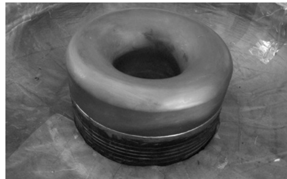
شکل ۵- مجموعه نازل با اتصال مفصل انعطاف‌پذیر در داخل عدسی انتهایی موتور
