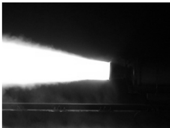
ج- اعمال نیروی جک و تغییر بردار پیشران به کمک مفصل منعطف، ۷ درجه به سمت بالا
