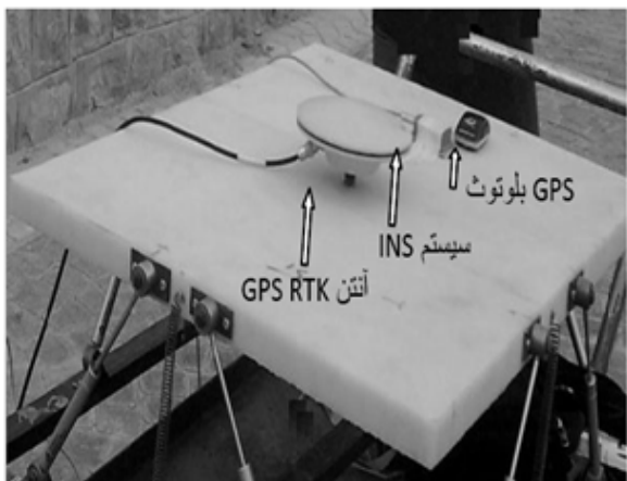
شکل ۴- GPS/INS وصل شده بر روی وسیله نقلیه مورد استفاده در آزمایش میدانی
