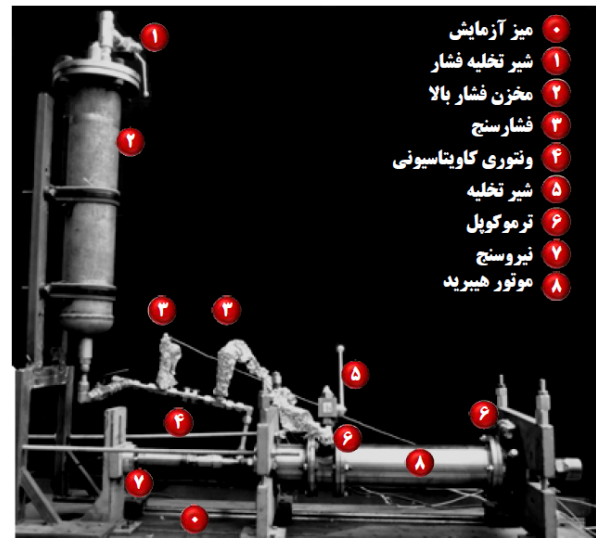
شکل ۹ - تصویر میز آزمایش و چگونگی نصب موتور هیبرید بر روی آن
