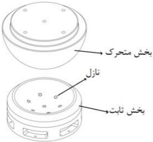
شکل ۷- شماتیک بخش‌های مهم یاتاقان هوایی نیم‌مکروی
