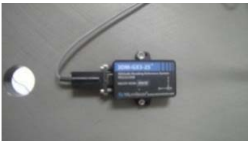
شکل ۱۰- حسگر تعیین وضعیت Microstrain-GX3
