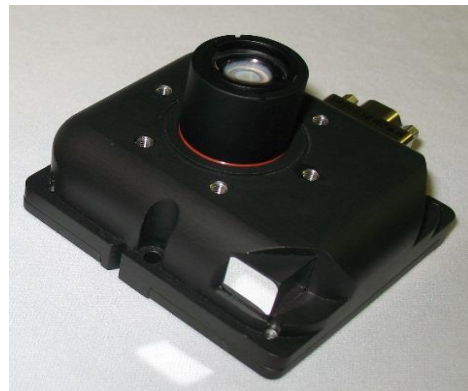
شکل ۲- حسگر ستاره ساخت شرکت سینکالر بدون بافل روی آن - مکعب آینه ای دستگاه بدنه حسگر (BodySS) را تعریف می‌کند. [12]
