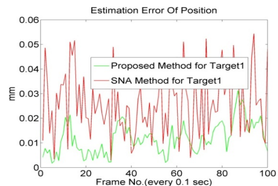
شکل ۱۰- خطای تخمین موقعیت یکی از ستاره‌ها در حرکت دورانی با \sigma = 0.02 و لرزش ۰/۵ درجه بر ثانیه
