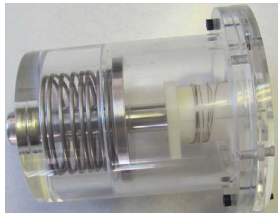
شکل ۷- قرقره‌ها، پیستون و نمونه آزمایشگاهی بعد از مونتاژ
