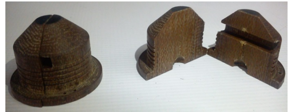
شکل ۱۶- قرقره‌های ساخته‌شده از فیبر استخوانی
