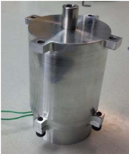
شکل ۱۸- نمونهٔ مونتاژشدهٔ پین پولر در سطح مهندسی
