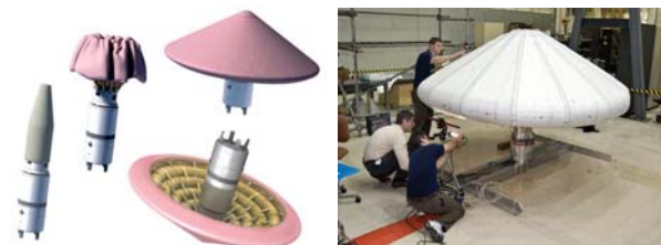
شکل ۴۰- سپر حرارتی بادشونده (ناسا-۲۰۱۴) [۶۹]
