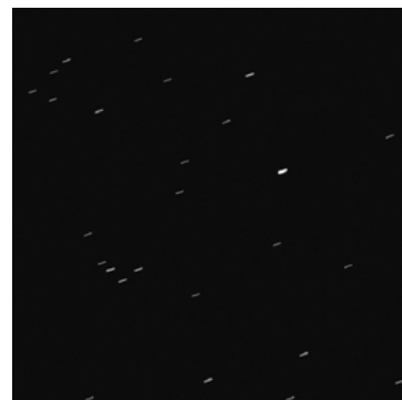
شکل ۱۴- شبیه‌سازی کشیدگی تصویر آسمان شب ناشی از دینامیک بالا و یا زمان نورگیری زیاد
