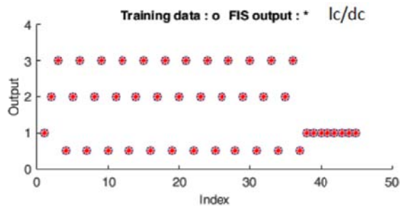
شکل ۹- آموزش مدل فازی-عصبی-تطبیقی برای داده‌های جدول ۲، نتایج تحلیل پارامتریک به‌عنوان ورودی مدل، l_c/d_c به‌عنوان خروجی
