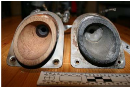
شکل ۱- (الف) پروفیل نرخ انتقال حرارت در نازل (ب) مقایسه نازل سیلیکانفولیک قبل و بعد از پرواز [۱۰].
