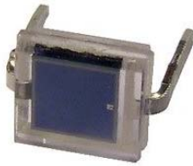
شکل ۲- فوتودیود نوع BPW34
