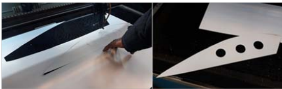
شکل ۱۳- برش لیزر شابلون ایرفویل دارای Cross point
