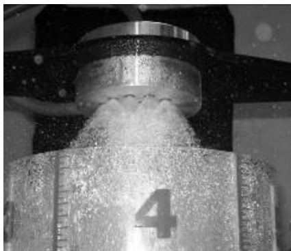
شکل ۱۷- نمایش برخورد چترهای پاشش از صفحه انژکتور
