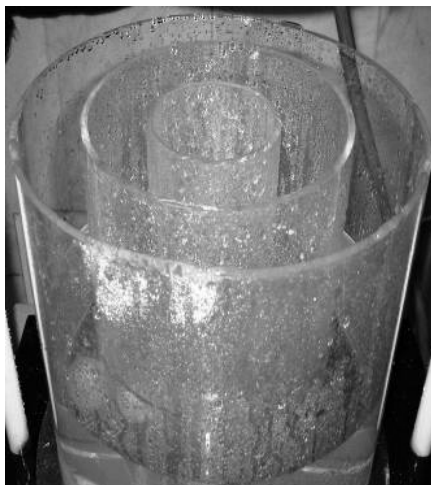
شکل ۸- شماتیک کلکتور شعاعی ساخته شده
