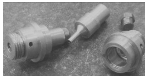
شکل ۳- انژکتور پیچشی ساخته شده از جنس برنج
