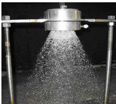
شکل ۱۶- نمایش چتر پاشش تشکیل شده از صفحه انژکتور
