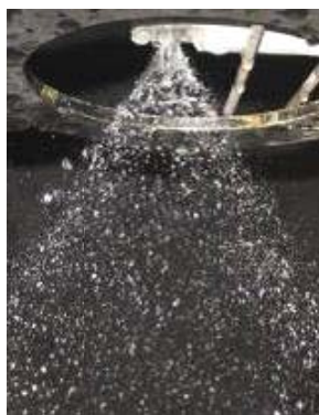
شکل ۱۱- نمایش زاویه چتر پاشش تشکیل شده از نازل خارجی
