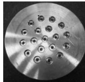
شکل ۵- نمایش خروجی صفحه انژکتور دایروی
