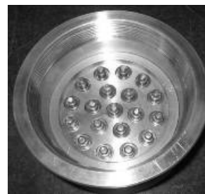
شکل ۶- نمای قرارگیری انژکتورها دایروی درون پولک جداکننده
