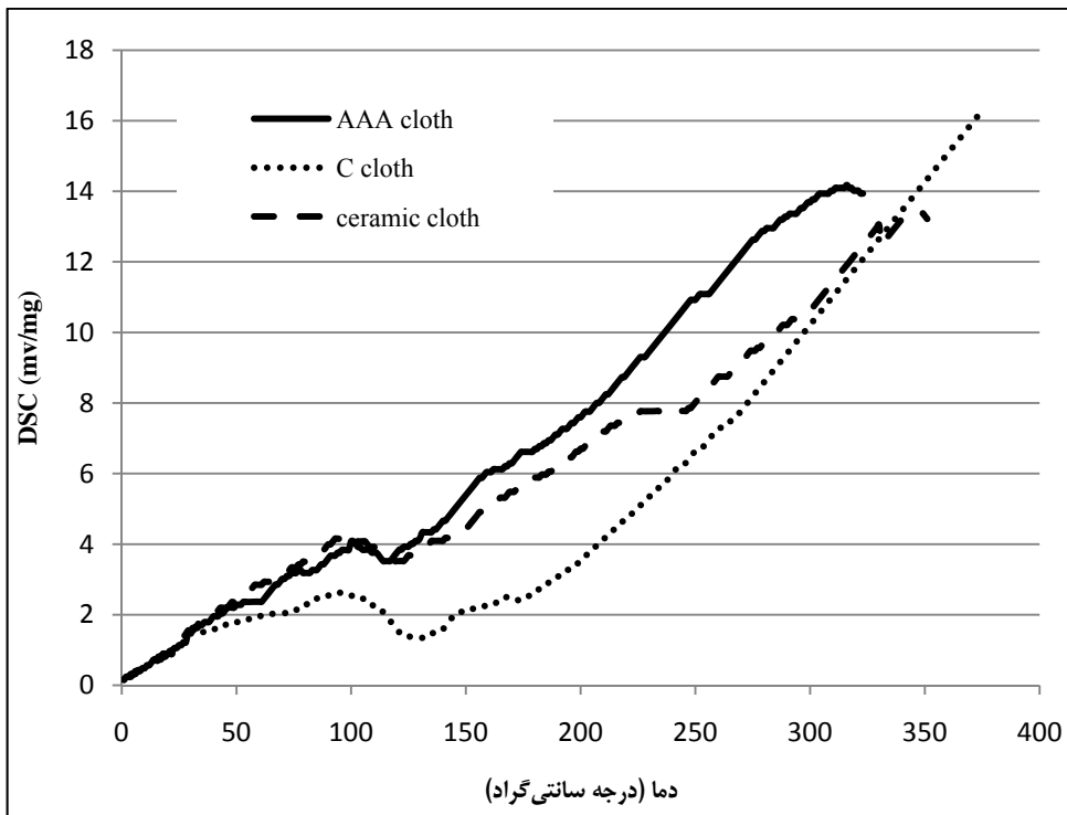
شکل ۸- منحنی‌های ظرفیت حرارتی ویژه قطعات کامپوزیتی
