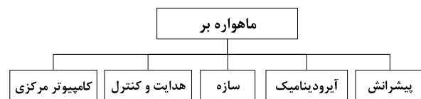
شکل ۵- زیرسیستم‌های یک ماهواره بر
