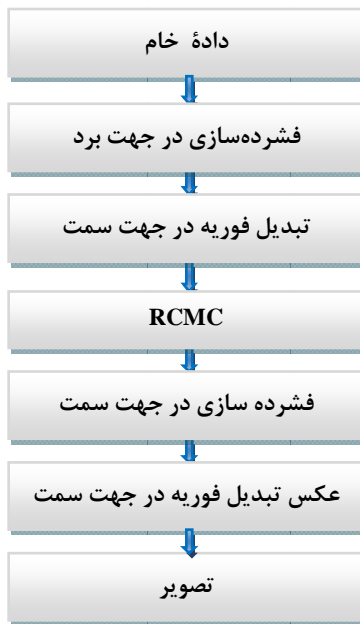
شکل ۴- بلوک دیاگرام RDA [۵]
