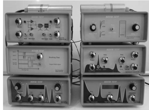
شکل ۶- ماژول‌های الکترونیکی سیستم اندازه‌گیری طول عمر پوزیترون
