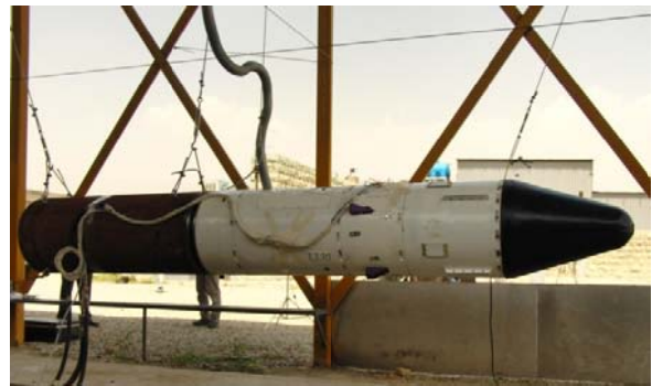
شکل ۵- تصویری از کاوشگر و جرم معادل موتور در حالت معلق قبل از جدایش دماغه و جرم معادل
