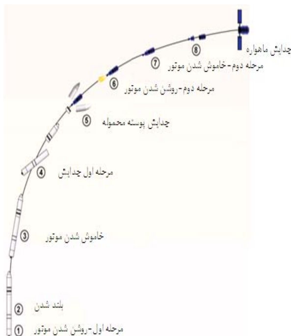
شکل ۱- مراحل مختلف در مسیر قرار گیری ماهواره در مدار که باعث اعمال بار دینامیکی بر روی ماهواره می‌شوند.
