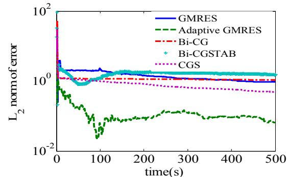
شکل ۲- نرم خطای تخمین روش‌های مختلف در پاسخ به ورودی تصادفی برای مدل یک درجه
