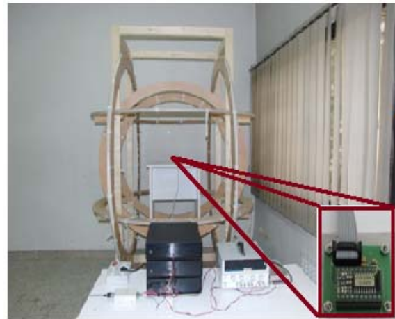
شکل ۴- نمایی از یک سیم‌پیچ هلمهولتز و یک حسگر مغناطیسی سنخ در مرکز آن
