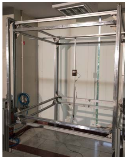
شکل ۷- بستر آزمون یکنواختی میدان مغناطیسی
