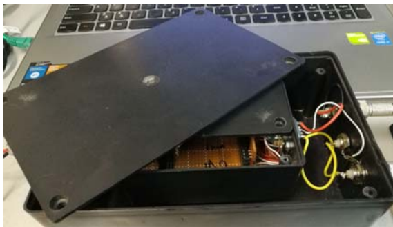
شکل ۳ - جعبه ساخته شده به منظور تست قطعات فوتودیودی
