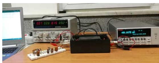
شکل ۶- چیدمان آزمایش جهت اندازه‌گیری پارامترهای الکتریکی فوتودیودها
