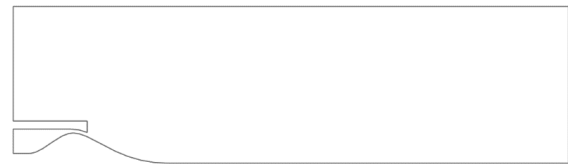
شکل ۶- طرح شیپوره آیروسپاک به همراه مرز دور
