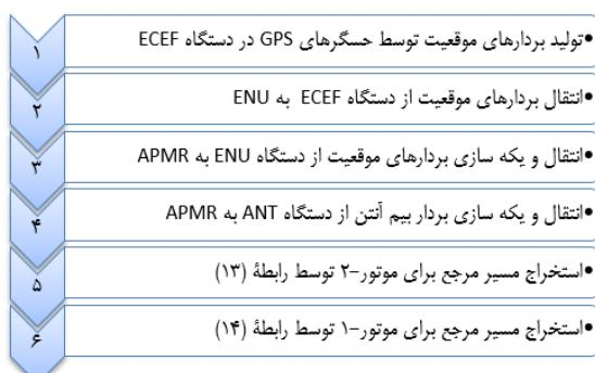
شکل ۴- روند استخراج مسیر مرجع برای موتور -۱ و موتور -۲ بر اساس GPS بردارهای موقعیت تولید شده توسط ECEF
