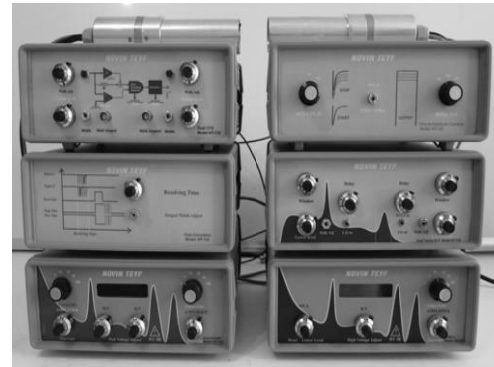
شکل ۶- ماژول‌های الکترونیکی سیستم اندازه‌گیری طول عمر پوزیترون
