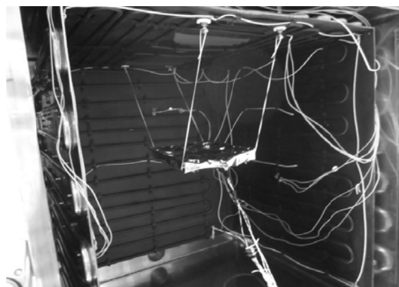
شکل ۶- نحوه قرارگیری مجموعه عایق چندلایه در محفظه خلأ حرارتی
