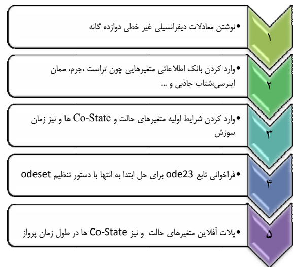
شکل ۴- الگوریتم حل ابتدا به انتها معادلات دیفرانسیلی غیرخطی [۱۲]
