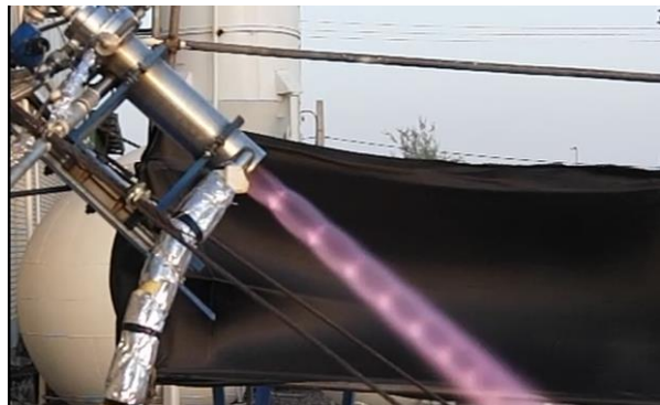
شکل ۷- نمایی از موتور در حال کار با سوخت متانول
