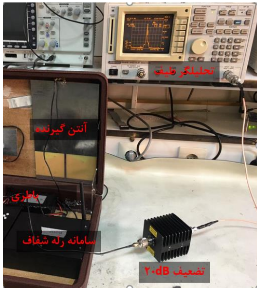
شکل ۱۷- ترکیب تست توان خروجی با کیف تست سامانه رله
