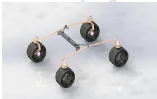
شکل ۸ - زیر سیستم چرخ و تعلیق در کاوشگر آرمیتا [13]
