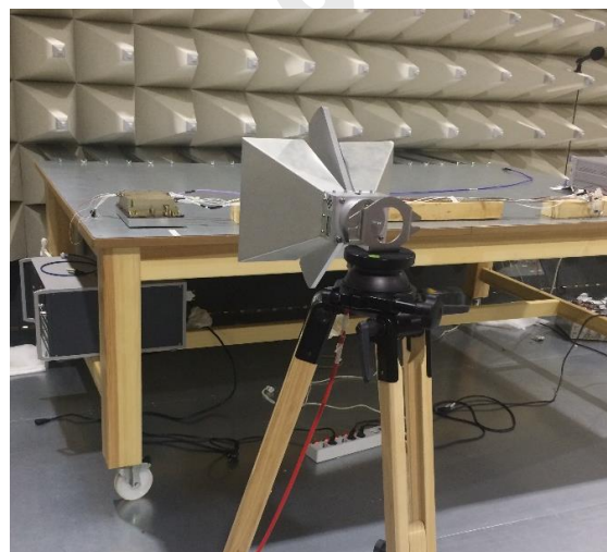
شکل ۱۲- چیدمان آزمون RS در آزمایشگاه
