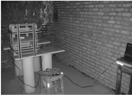
شکل ۱۲- نمونه اولیه پیچۀ هلمهولتز مربعی سه‌محوره در حال تست
