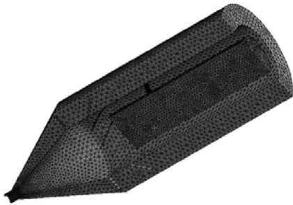
شکل ۳- مش‌بندی سه بعدی تتراهدرال بر روی انژکتور دوفازی ترکیب داخلی
